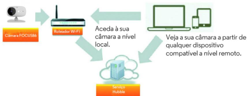
Quando um utilizador tenta aceder à câmara, o servidor Hubble autentica a identidade do utilizador e permite o acesso à câmara.
